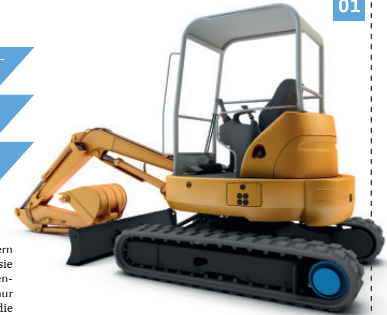
01 Zeitgemäß ausgerüstete Mini- und Kompaktbagger arbeiten besonders leise
